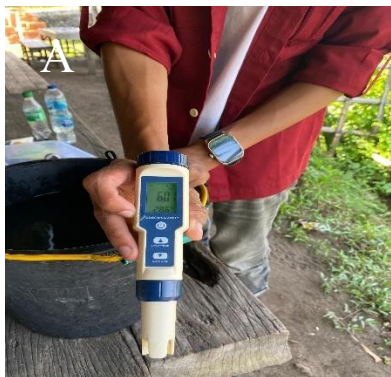
A. Pengukuran ph dan suhu di lokasi 1
