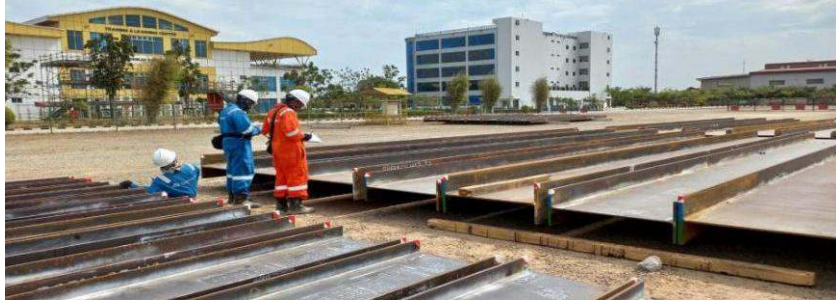
Gambar 2. 2 Baja ASTM 131 atau ABS Grade
