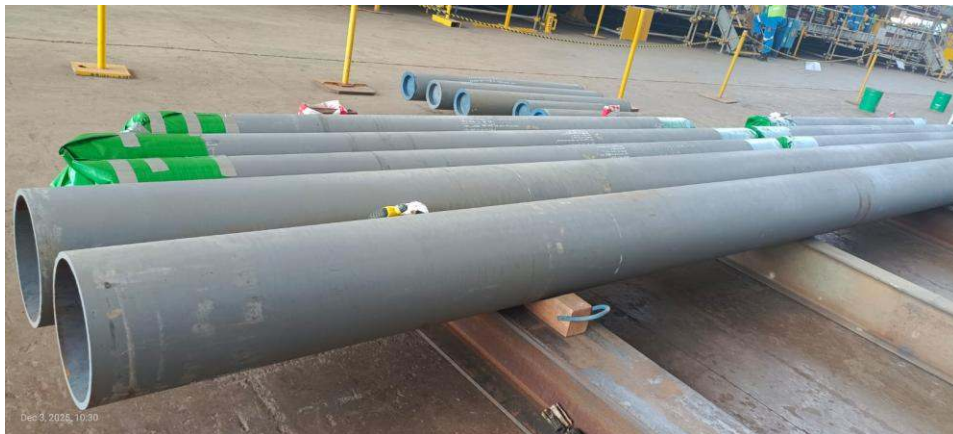
Gambar 2.3 Baja ASTM 131 atau ABS Grade utk Pipa Rolling
