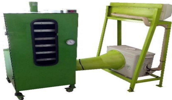
Gambar 2.6 Cabiner dryer yang memanfaatkan panas terbuang kondensor AC sumber : (Lestari dan Samsuar, 2023)
