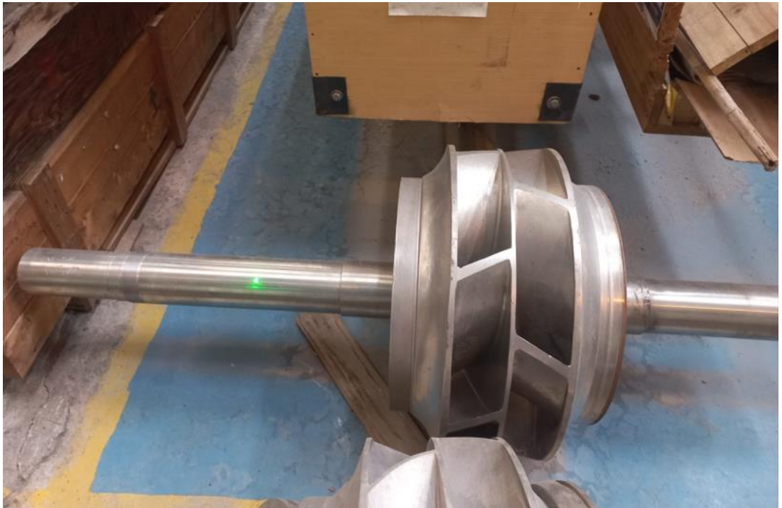
Gambar 5. 1 Spare Part Poros Pompa ZVV dengan Material Duplex SS 2324
