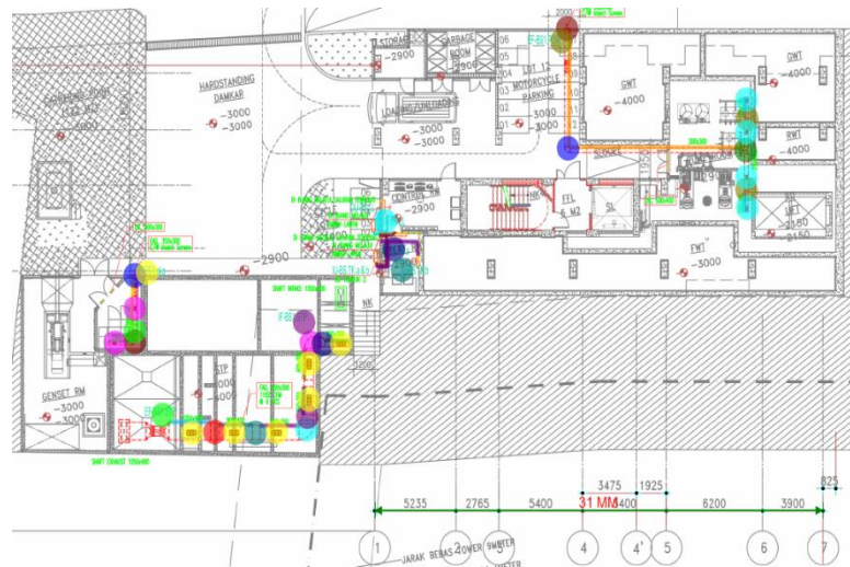
Gambar 3. 13 Denah Pekerjaan Tata Udara Lantai Basement
